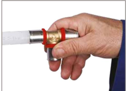
El accesorio de la medida adecuada a la tubería debe introducirse en la misma, con el casquillo puesto en su junta, hasta que se visualice la tubería en los testigos del casquillo.
