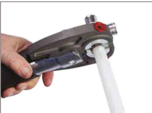
Usar insertos TIPO "RF" de la medida adecuada al accesorio. Colocar los insertos en la mordaza e introducir el accesorio con su junta en contacto con ellos. Prensar comprobando que la mordaza cierra completamente.
